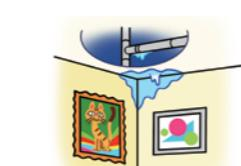
③給排水管の取付ミスにより、水が漏れ、壁が汚損した。
