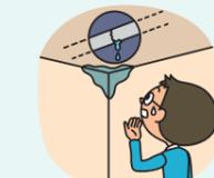
③ 給排水管の取付ミスにより、水が漏れ、壁が汚損した。
